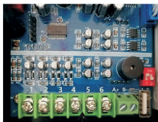
Borne de control pentru conectarea electrica la sonda/plutitor/presostat
